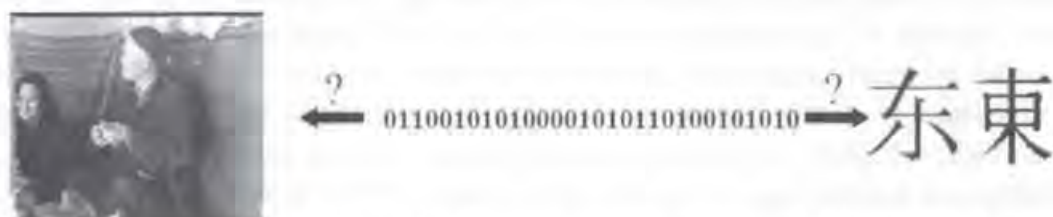
Figura 2. El problema básico de interpretar una secuencia de bits: ¿qué tipo de señal está codificada en una secuencia determinada?
